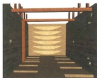
Tapia calcostrada en construcción. Vista Interior del encofrado
